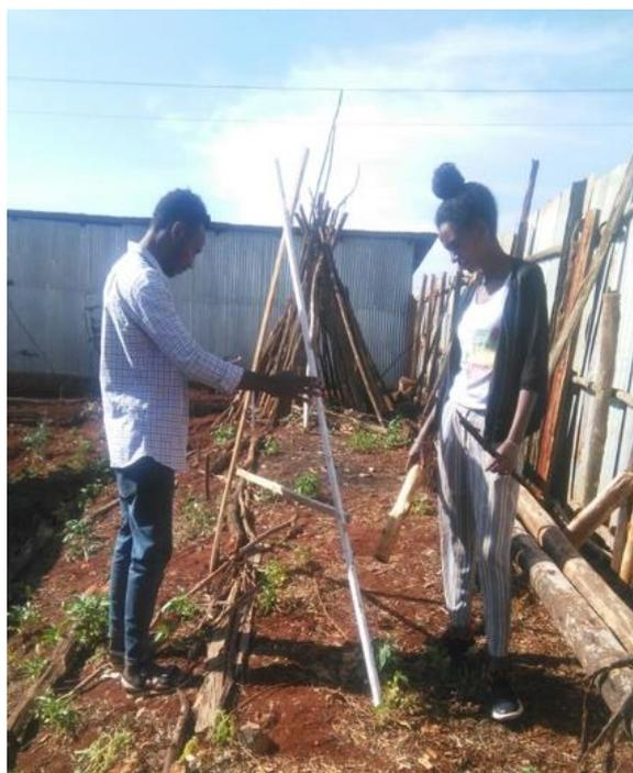
Über sog. A-Frames werden Böden gemäss den Höhenlinien vermessen. Dies ist wichtig, damit Regenwasser vor Ort versickert und Erosion reduziert wird.
